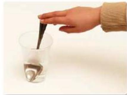
▲ Transferencia de calor por conducción.
